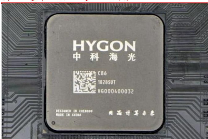
图 22 基于 8 核心 Dhyana 芯片样品
