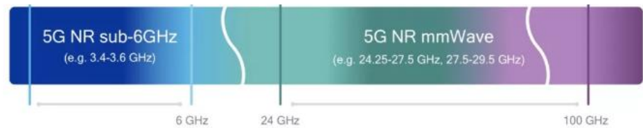
图表 26: 5G 传输频段: sub-6 & 毫米波
