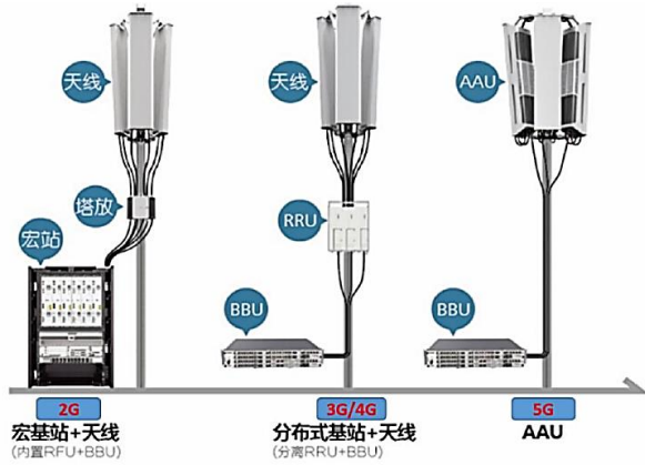
图表 38: 2G 到 5G 基站的结构变化
