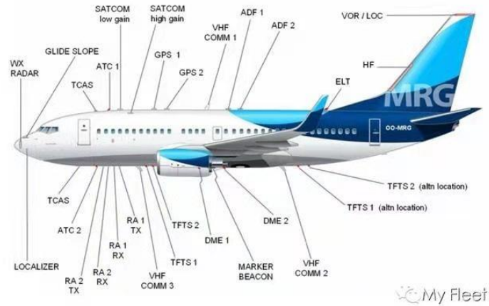
图表 28: LCP 纤维用于大飞机射频天线
