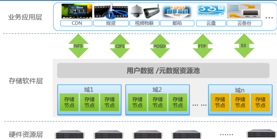
图表 40: 自研 CSS2000 云存储产品架构
