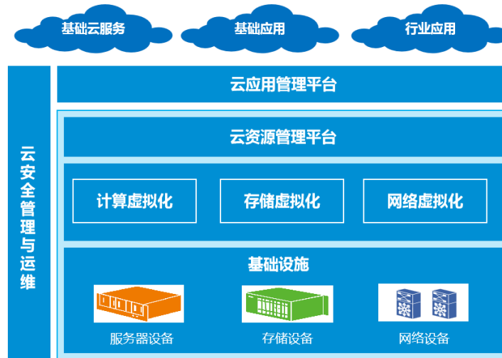
图表 39: 中兴通讯 uSmartCloud 云数据中心解决方案架构
