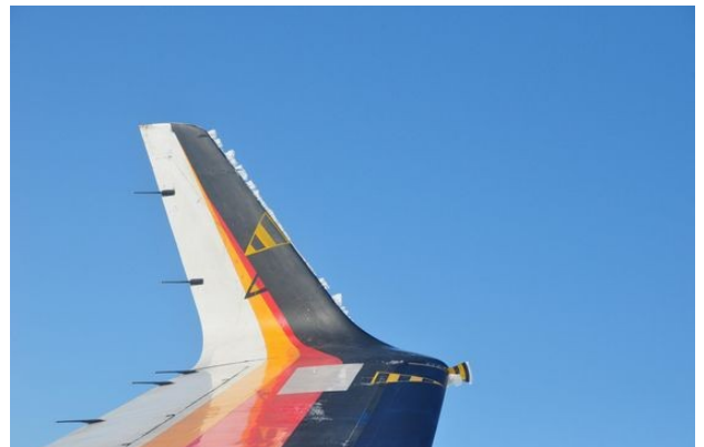
图 19 自然结冰试验（翼尖结冰情况）
