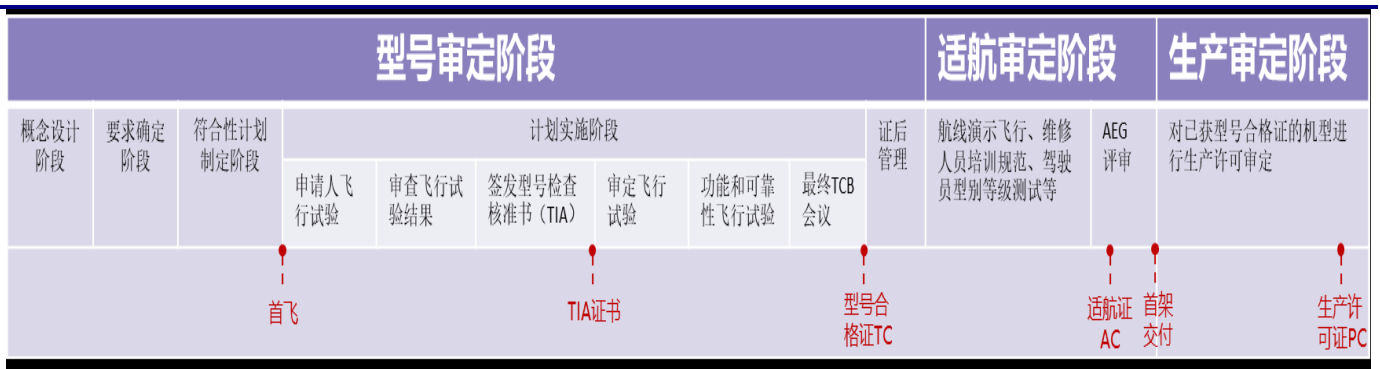
图 13 新研制飞机取得适航证主要流程
