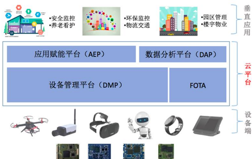
图表 41 TurboX Cloud 智能物联网云平台整体架构
