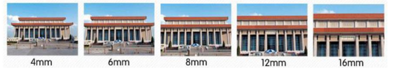
图 7：焦距对成像大小的影响
