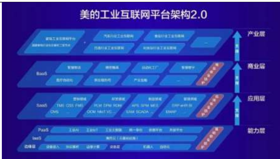
图 27: 美的工业互联网 2.0 架构分为 4 层
