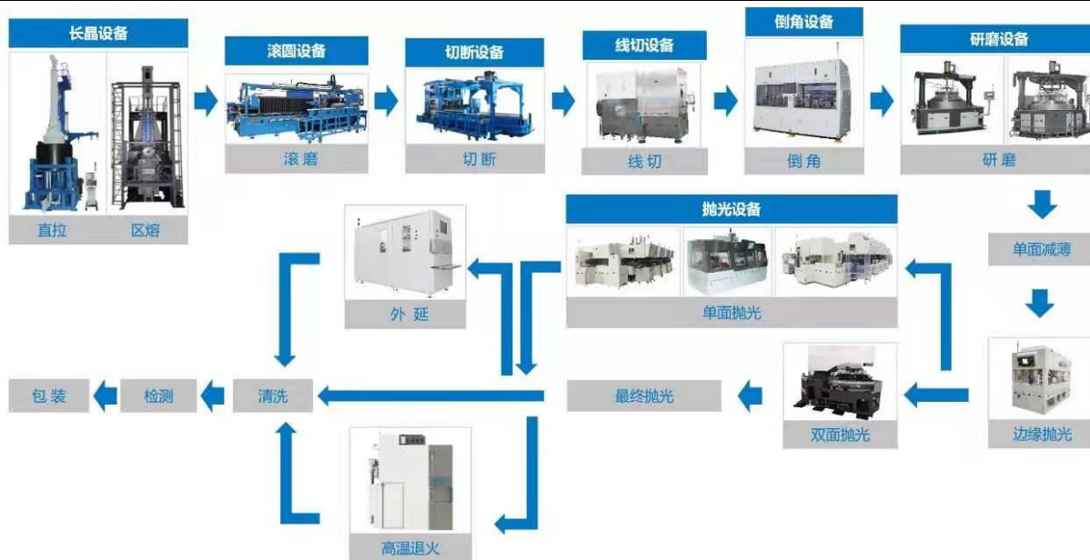
图 10: 公司形成了生长、切片、抛光、外延四大核心装备为主的完整产业链布局
