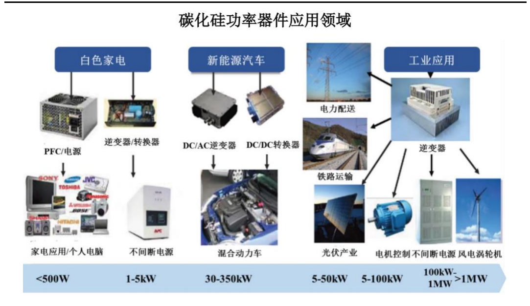
图 22：SiC 功率器件广泛应用于白电、新能源汽车、光伏等场景
