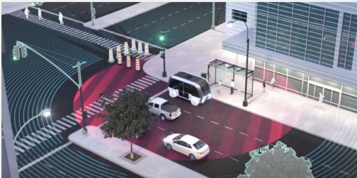
Flash LiDAR产品工作示意图（红色部分为Flash探测激光覆盖区域）
