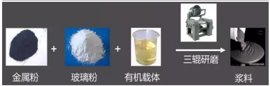
图43：电阻浆料是制造厚膜电阻的主要材料
