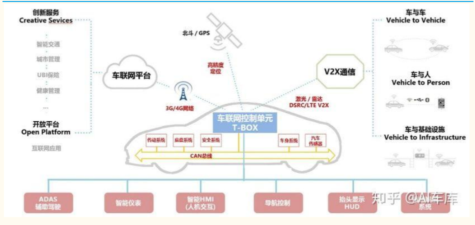
图表 24：T-Box 通信示意图
