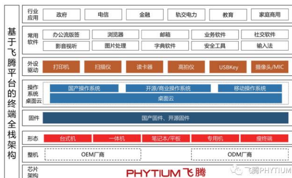
图26: 基于飞腾平台的终端全栈架构
