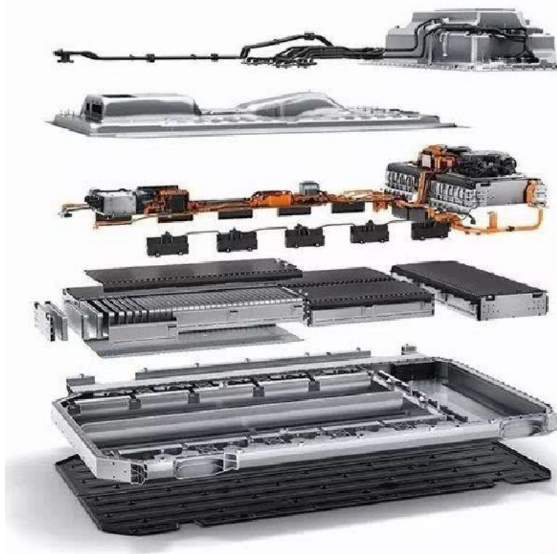
图 15: 电池包 PACK 的结构
