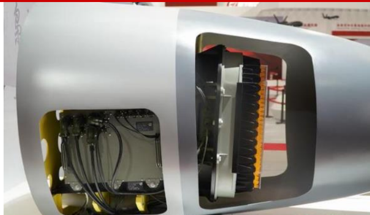
图 62 LKF601E 机载风冷有源相控阵雷达
