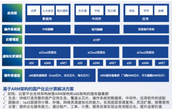
图 17：深信服超融合 ARM 虚拟化方案架构
