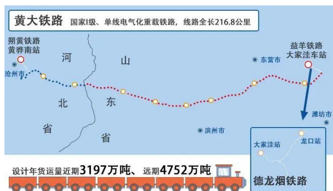
图表 28:黄大铁路规划示意图
