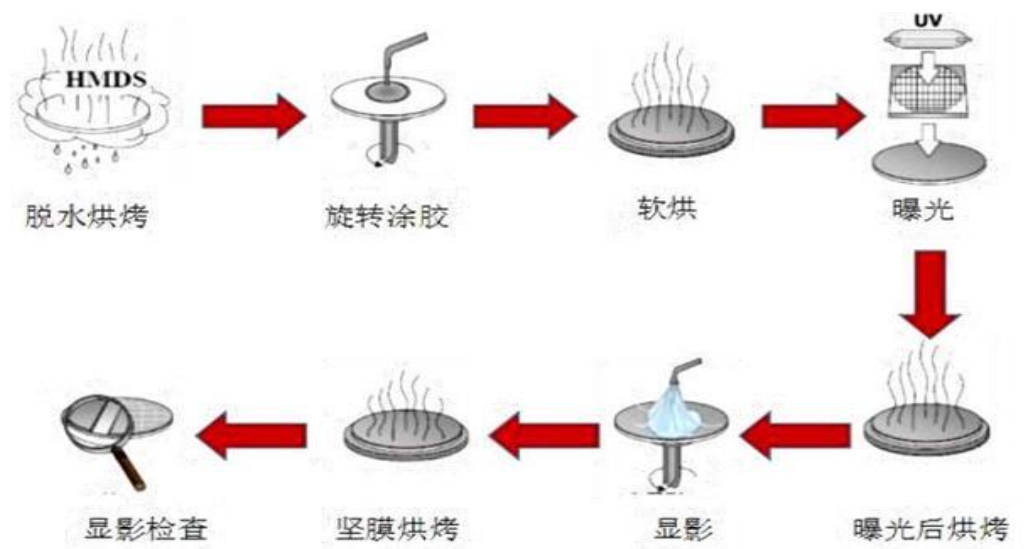
图13: 光刻工艺中的涂胶、烘烤及显影
