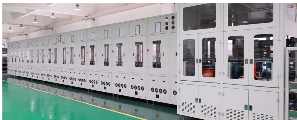
图 26：杭可高温加压软包动力电池夹具化成设备示意图
