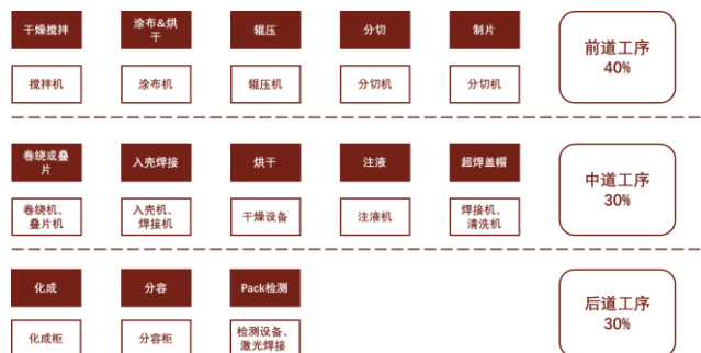
图 1：锂电池生产工序分为前道、中道、后道
