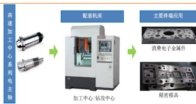
图 19：电主轴在加工中心中的应用
