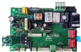
控制板：核心部件为MCU微处理器控制电路；MCU用于变频模块、模拟传感器、各种驱动芯片的控制
