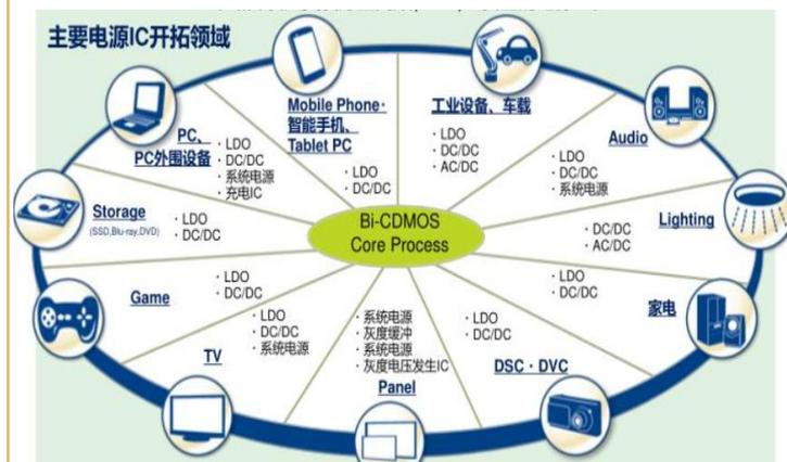
电源管理芯片主要采用Bi-CDMOS和BCD的成熟工艺制造，对于线宽要求不高，但是，对于电路设计的抗干扰、耐高电压击穿、高功率密度等特性，需要经验积累，产品生命周期较长；随着电子系统复杂化需要将系统与电源隔离；电源管理芯片用于保障电子设备中，各模块电压在可承受范围，整体需求量和技术要求不断升级，重要性逐步提升。
