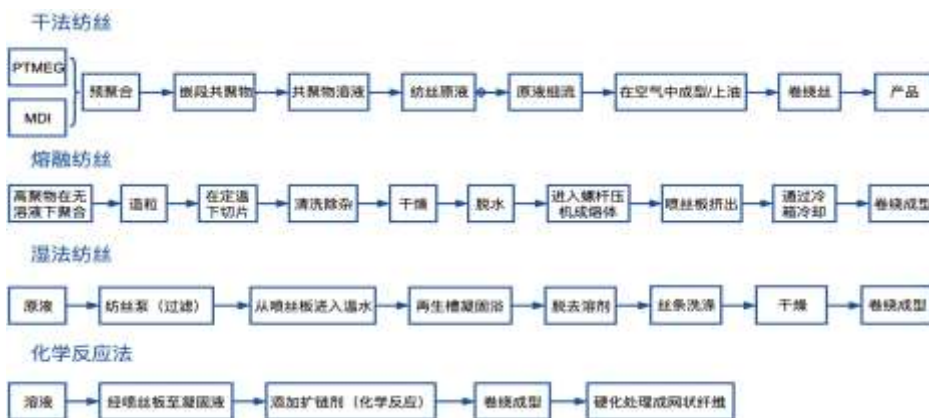
图 4: 氨纶生产工艺流程简图
