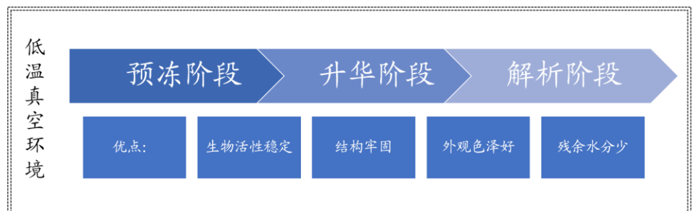
图表 11 人纤维蛋白原制备过程中的冷冻干燥步骤及工艺优点
