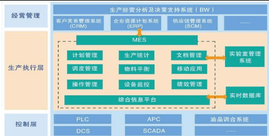
图表 108 中控 MES 软件体系架构 1.0
