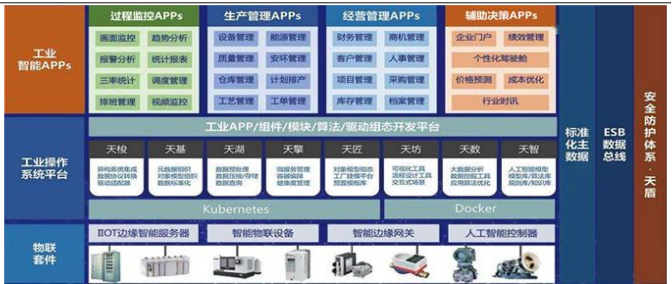
图表 111 蓝卓工业操作系统赋能工业软件的平台化开发和模块化部署
