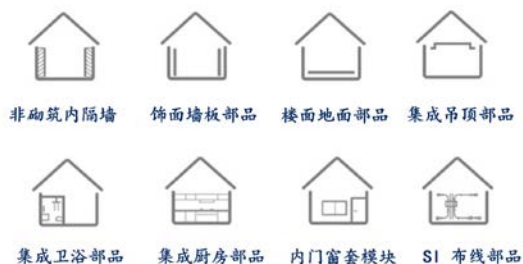
图 3：装配式装修可拆分为八大模块
