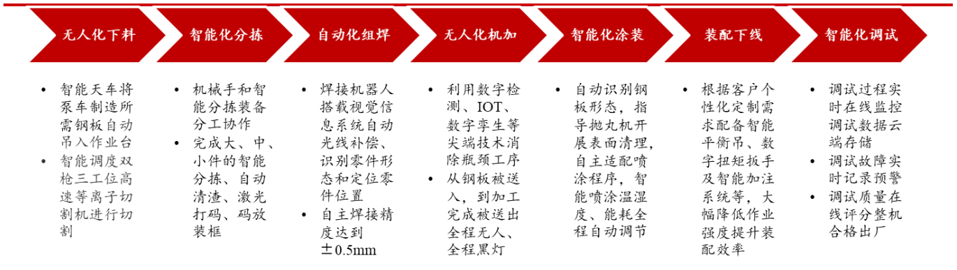
图 112 三一的 18 号智能工厂智能制造流程
