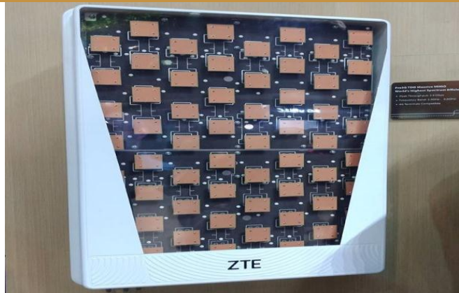
图 22: 中兴通讯 TDD Massive MIMO2.0 基站天线
