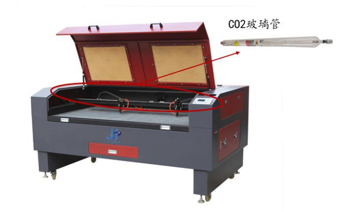
图 10：二氧化碳激光器需整体固定在机床，柔性化程度低
