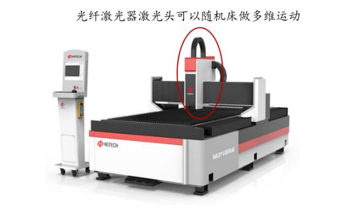
图 11：光纤激光器激光头小巧灵活，可以做多维运动
