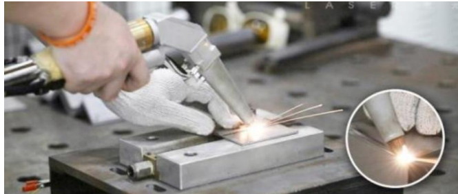
图 23：手持激光焊方便、清洁、效率高
