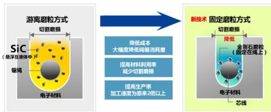
图 16: 金刚石线切割工艺是新一代晶硅片切割工艺
