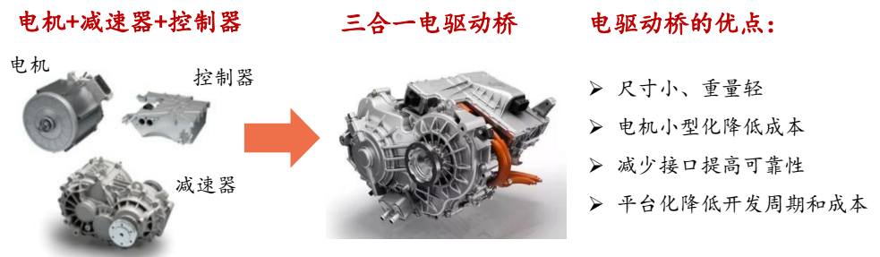
图15：三合一电驱动桥
