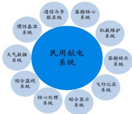
图7：民用航电系统的组成
