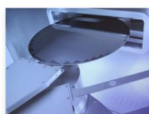
图 32: 电子束图案晶圆检测系统案例
