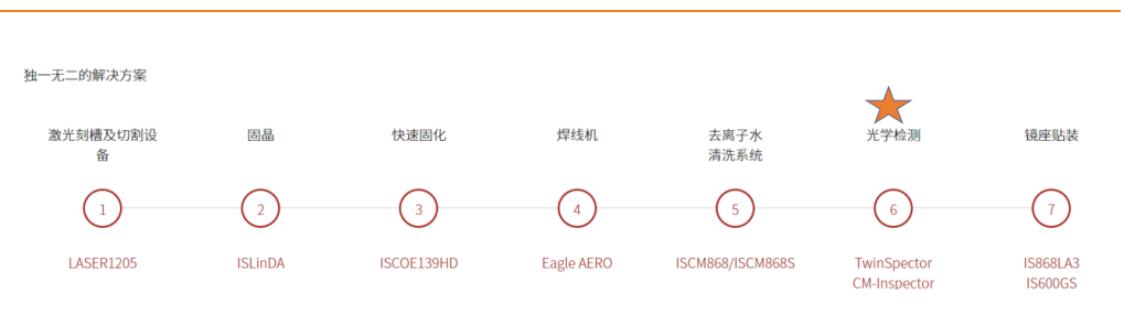
图 43: ASMPT 图像传感器封测流程
