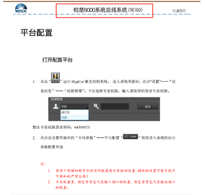
图 34：万顺兴新款总线切割头说明书，主动介绍柏楚 FSCUT8000 总线系统的配置方式
