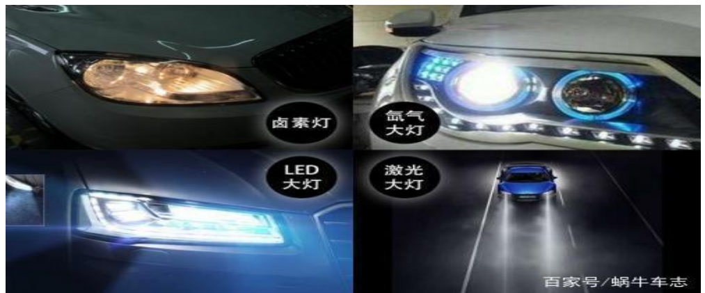
图3：卤素灯、氙灯、LED灯、激光灯对比
