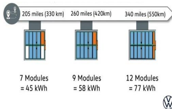
图15: ID.3 通过改变模组数量提供不同续航里程
