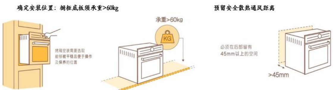
图表7. 嵌入式厨电安装对位置的要求较高
