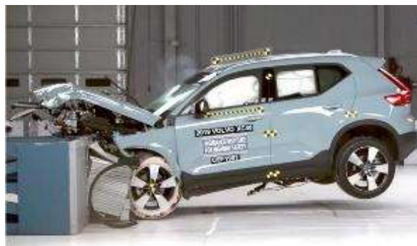
图 46: 正面碰撞的第一条传导路径
