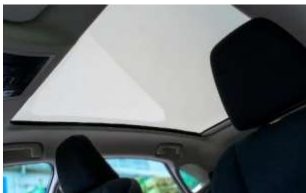
图 34：汽车调光玻璃的雾化模式
