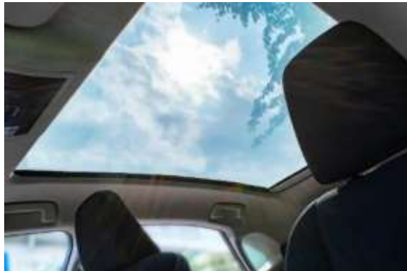
图 35：汽车调光玻璃的透射模式
