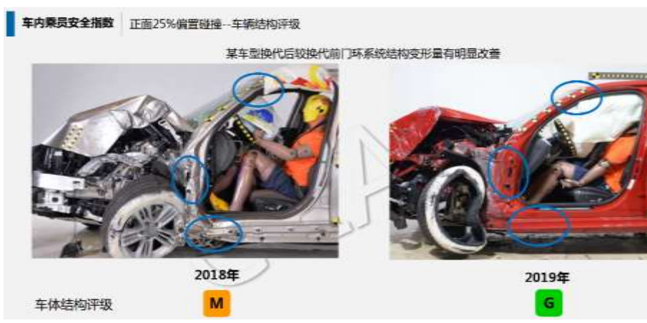
图 47: 正面碰撞的第二条传导路径
