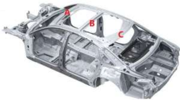
图 43：车顶有 3 根横梁的白车身结构
