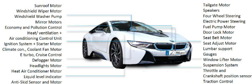
图 25：高性能钕铁硼在中高端传统内燃机汽车中的应用组件
