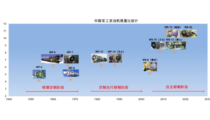
图表 80：中国军工航空发动机自主研发进程
