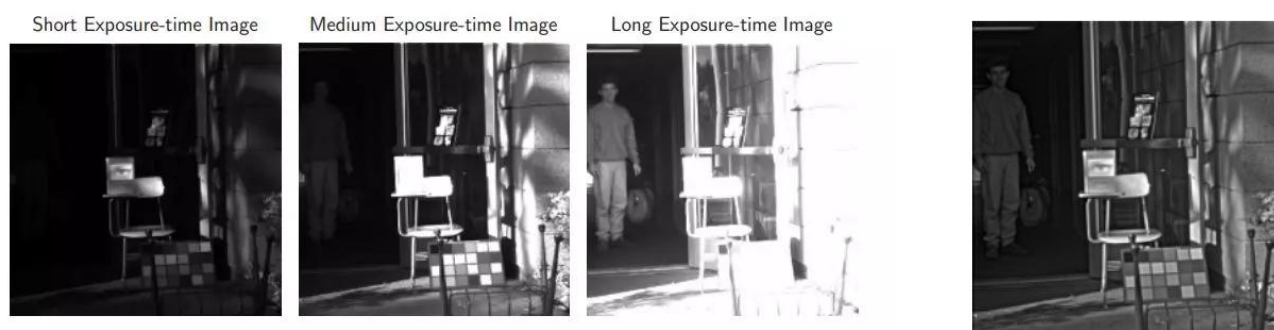
图表 22：时域曝光技术：采用不同曝光时间得到左边三幅图，最后合成右边图像
