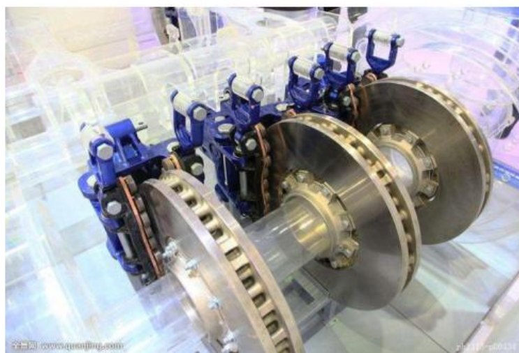
图表 17: 闸片与制动盘组成一对摩擦副
