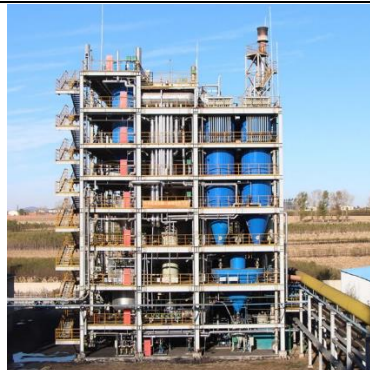
图表 28：常压气流床（科达二代炉技术）
