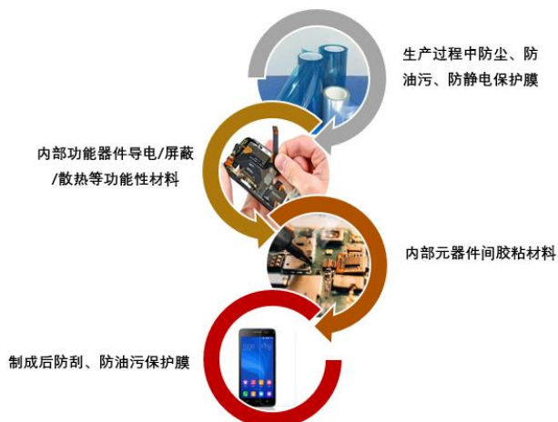
图 10：智能手机生产需要多种类功能性涂层复合材料
