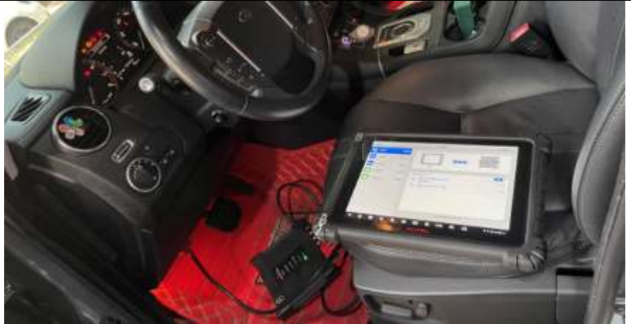
图 7: 诊断设备通过 OBD 接口接入
