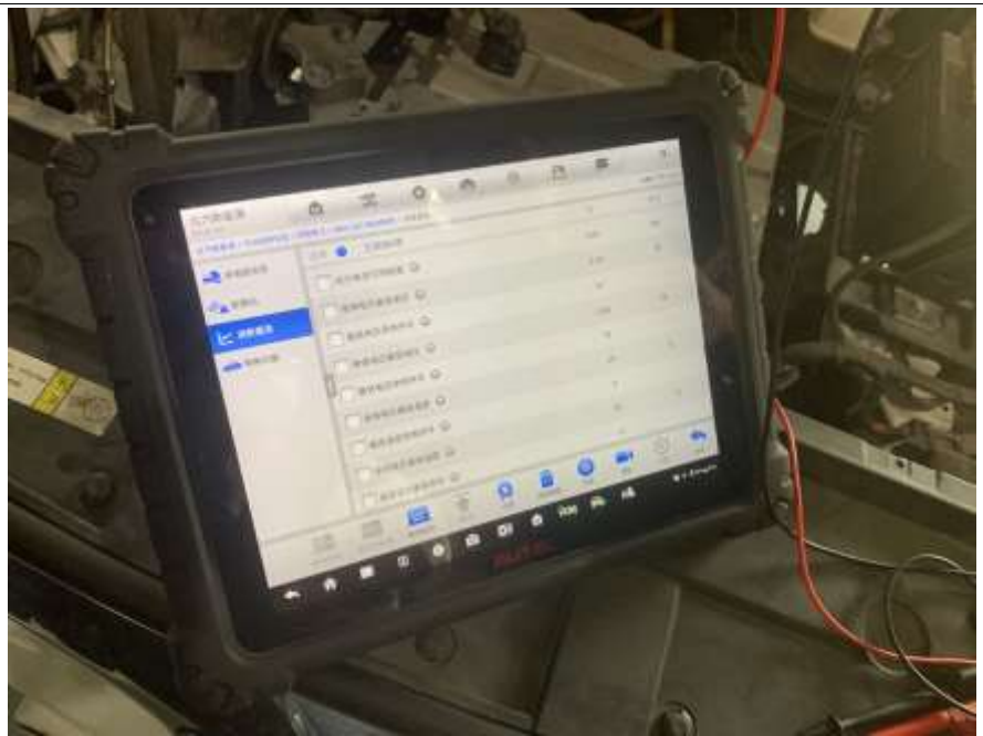
图 5：诊断设备进行动力电池系统（BMS）数据流读取
