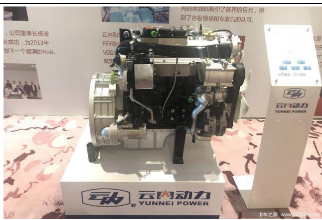
图表31.云内动力 德威 D25 系列 2.5L 国六 柴油发动机
