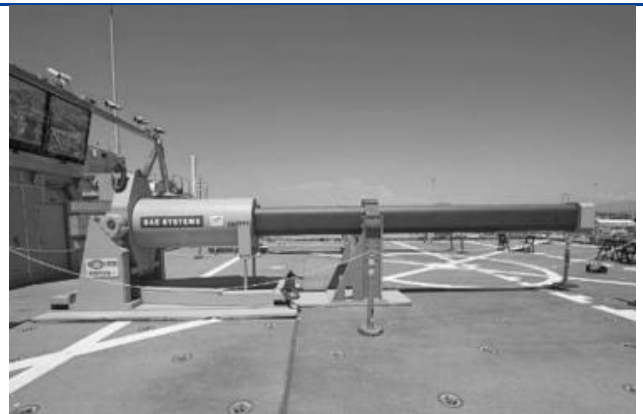
图表 18: 美国 BAE 系统公司研制的电磁轨道炮样机
