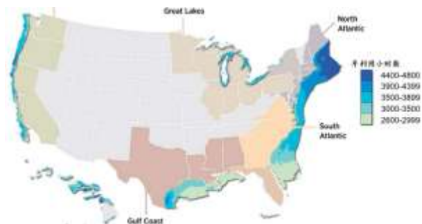
图 1: 美国五大海风资源区 100 米深度技术可开发量下的年利用小时数
