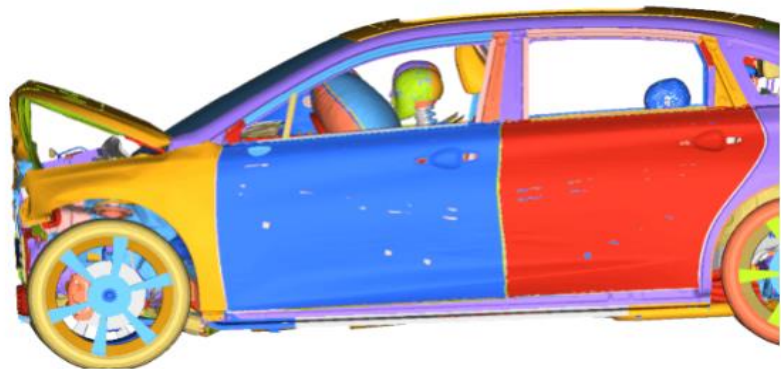
图表 63 借助 CAE 软件模拟仿真汽车碰撞安全性试验
