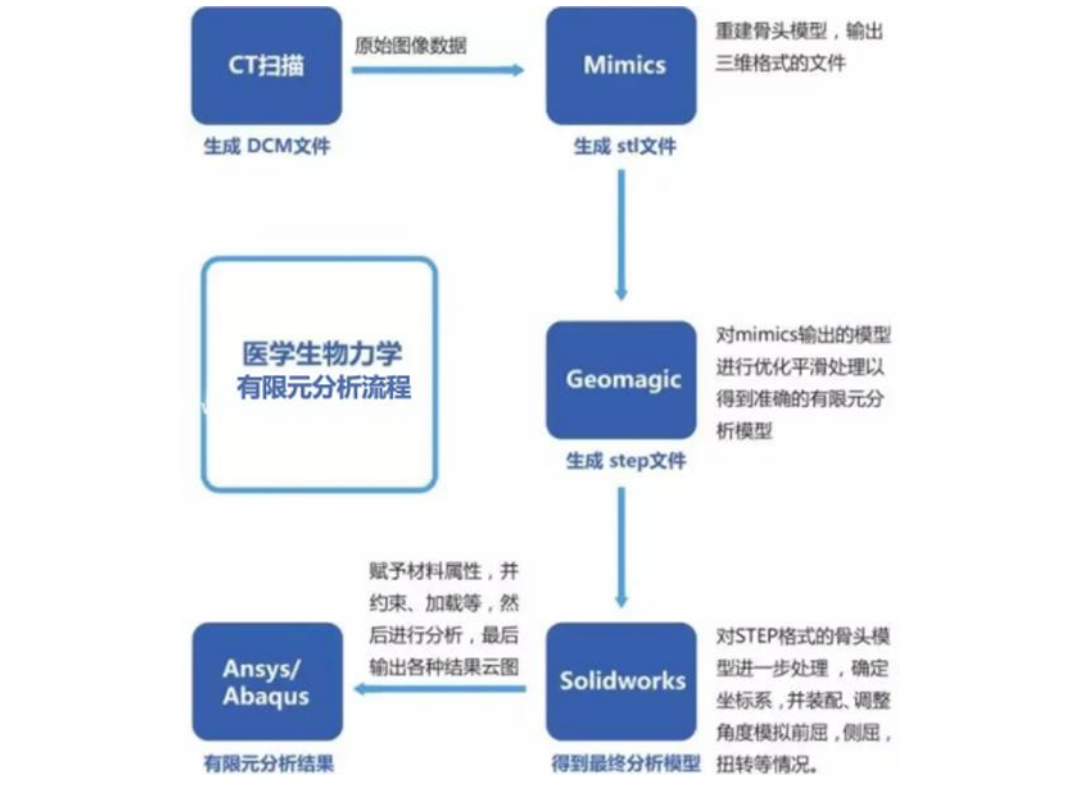
图表 70 CAE 软件进行医学生物力学有限元分析的流程
