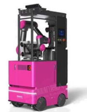
墙砖铺贴机器人
