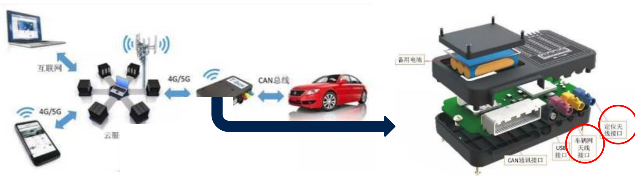
图 93：通过T-BOX实现车辆和云/手机的通信
